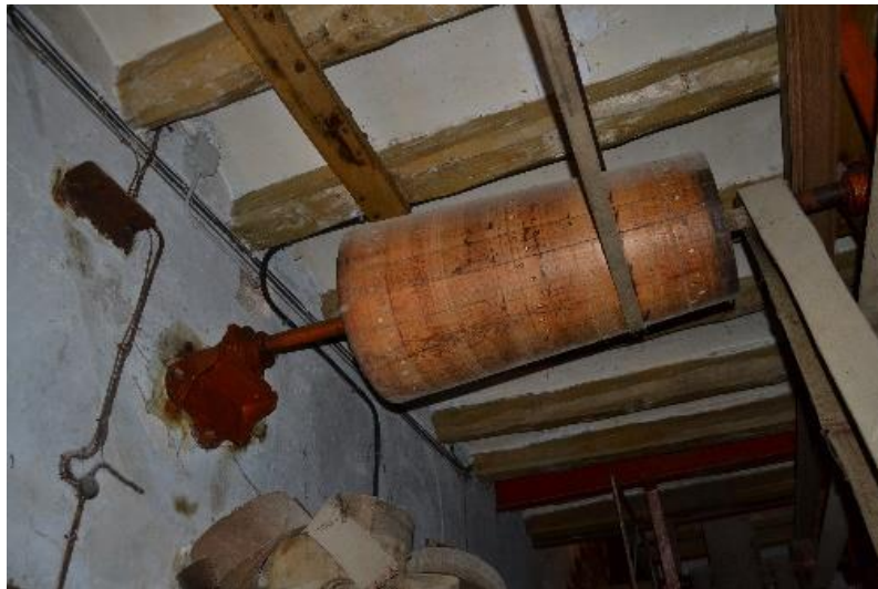
Ruedas y mecanismos de transmisión en la planta baja del molino 149
