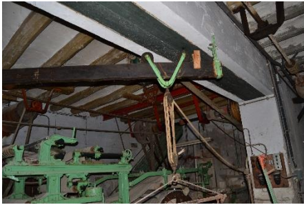
Polea múltiple para sacar las bobinas de la máquina.
