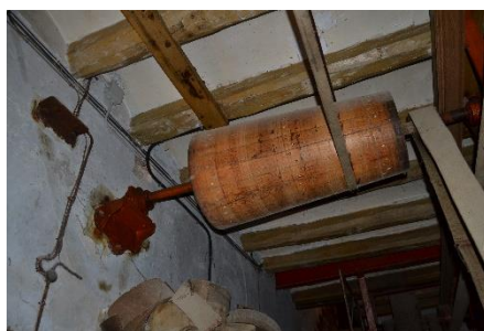
Ruedas que transmiten la energía del agua a las máquinas.
